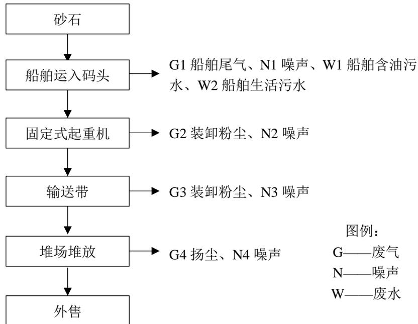
图 4-1 项目工艺流程及产污节点图
