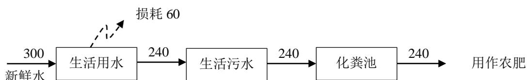
图 2-1 本项目水平衡图 (t/a)
