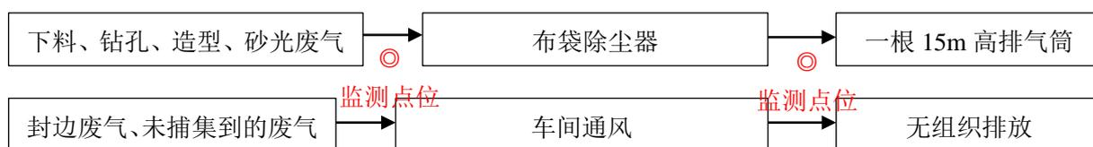
图 3-1 废气处理工艺流程图及监测点位图
